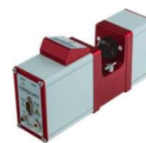
Figure 1. Appareil conçu pour contrôler le diamètre de fils fins www.cersa-mci.com/las-laser-diffraction-sensor/
